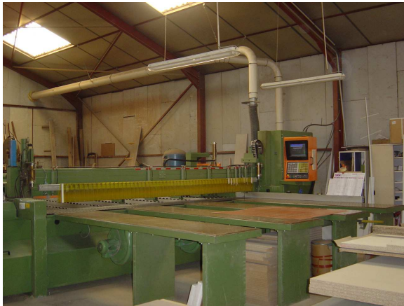
Scie à débit pour panneaux agglomérés
